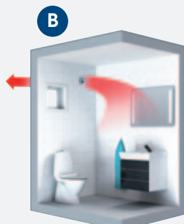
Suoraan ulkoseinän läpi
